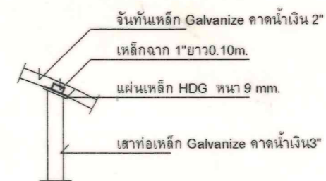
แบบขยายแผ่นเหล็กหัวเสา
