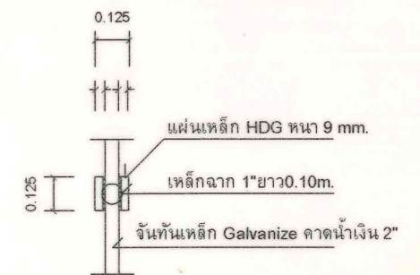
แบบขยายแผ่นเหล็กหัวเสา
