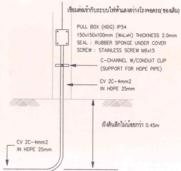
PULL BOX & HDPE PIPE INSTALLATION โรงจอดรถ
